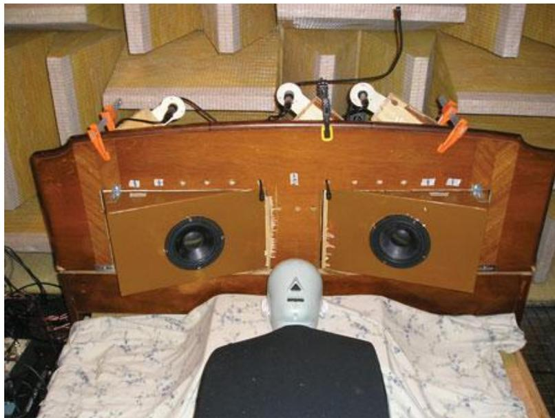
Figura nº 9: Instalación experimental para el control de ronquidos con CAR.
