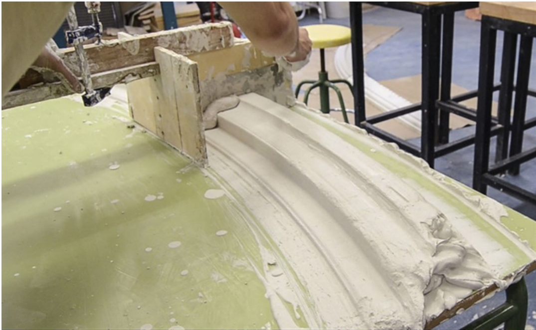
Fig. 204. Forjado de un arco mediante el sistema de terraja sobre banco. Foto del autor.
