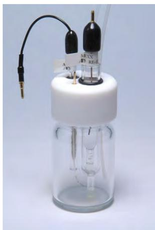
Figura 6. Celda voltamétrica y sistema de tres electrodos. Electrodo de trabajo (EPt o EAu de  $d=2\text{mm}$ ), electrodo de referencia 3M. Ag/AgCl con puente salino  $\text{KNO}_3$  0,1M, y electrodo auxiliar (hilo de Pt, diámetro 0,5 mm).
