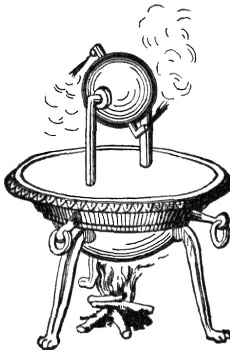
Fig. 9. Ilustración idealizada de una eolípila.
