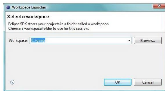
Figura 55 Ventana para la creación de un workspace en Eclipse
