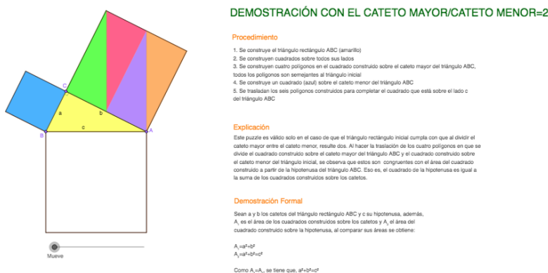
Figura B-2: Demostración del Teorema con el cateto mayor entre el cateto menor igual a 2.
