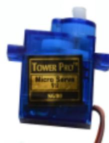
conformado por un motor y un circuito de control. En otras palabras, un servomotor es un motor especial al que se ha añadido un sistema de control. Existen dos tipos de servomotores, los que permiten un giro de 180 grados y los de rotación continua. Nosotros controlaremos uno que gira sólo 180°. Los servomotores son comúnmente usados en modelismo para controlar aviones, barcos o helicópteros, tanto en los sistemas de movimiento como de dirección. Servomotor SG90, muy común en el mercado.
