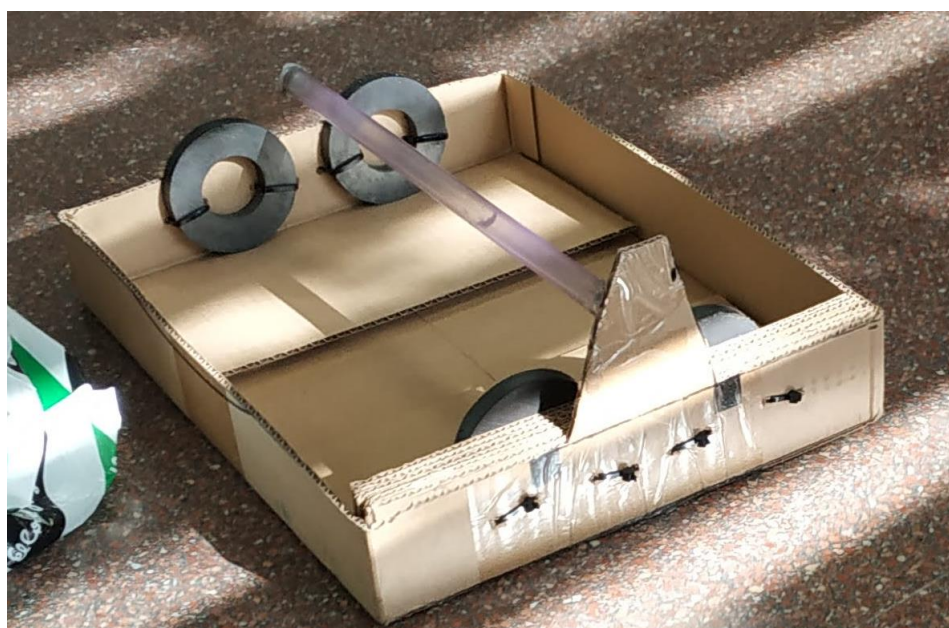
Figura 11. Montaje para dejar suspendido en el aire un tubo con imanes en sus extremos
