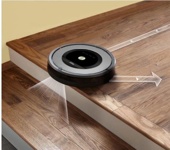
Ilustración 9: Mecanismo de detección las escaleras (fuente: roboticandautomationnews.com )
