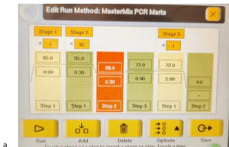
FIGURA 10. Programa utilizado en el termociclador para la elaboración de la PCR.
