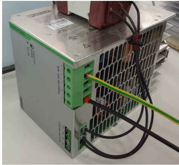
Fuente de alimentación Phoenix Contact Trio
