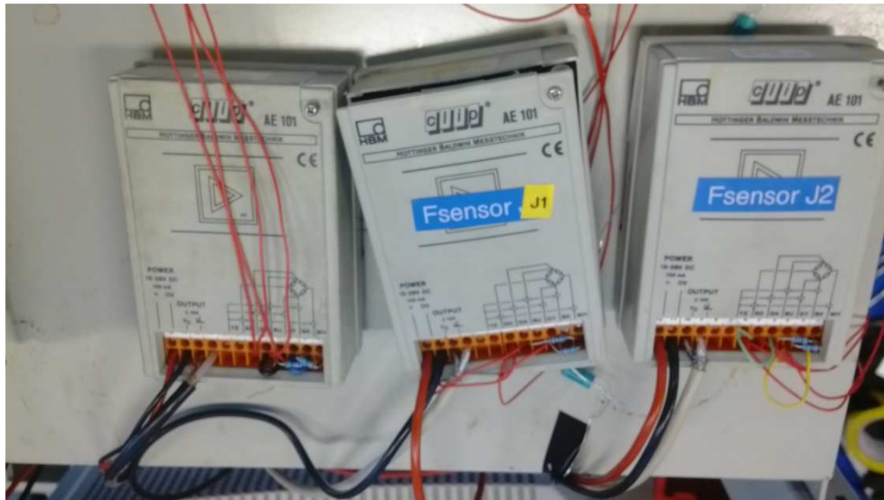
Figura 5.4 Amplificadores utilizados para cada puente de Wheatstone.
