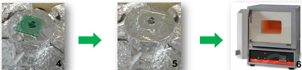
Depositar por spin coating a 3000 rpm durante 30 s.
