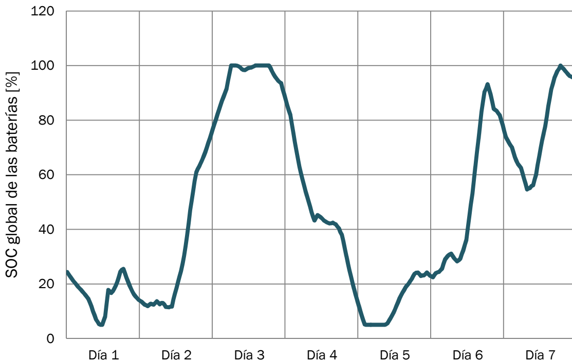
Fig. 27. Evolución del SOC de las baterías: Smoothing ( \omega=8 , 2MWh)
