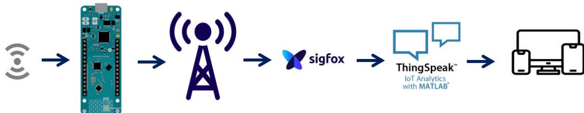
Ilustración 14. Esquema de la solución desarrollada en Sigfox.
