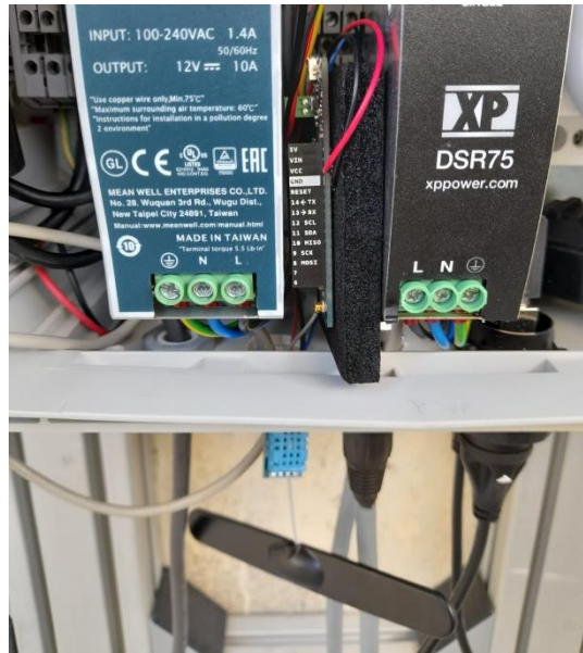
Ilustración 22. Fotografía de la solución desarrollada en Sigfox para este proyecto colocada en la ubicación final para realizar las pruebas correspondientes.
