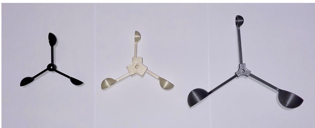
Ilustración 55. Comparación de rotores asimétricos impresos en 3D vs. un rotor simétrico. (izq.) Rotor simétrico; (centro) Diseño 1; (der.) Diseño 2.
