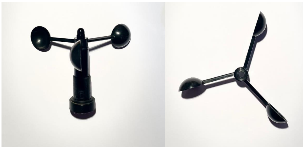
Ilustración 51. Anemómetro de tres cazoletas. (izq.) Vista general; (der.) Vista superior del rotor. La altura es de 85mm.
