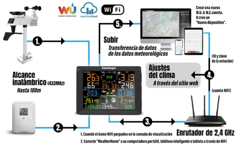
Ilustración 18. Esquema de conexión de la estación meteorológica FT0300. [14]
