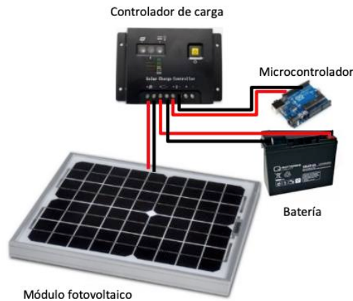
Ilustración 10. Esquema del sistema de alimentación de energía solar autónomo. [11]
