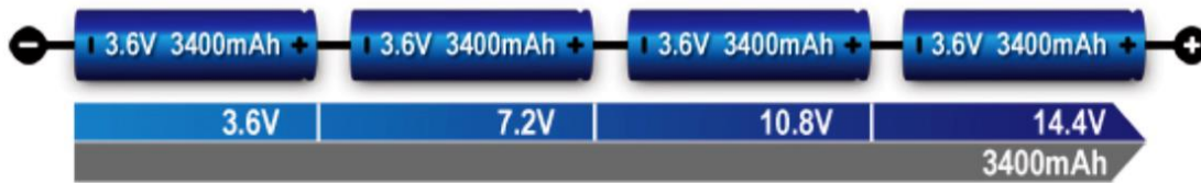
Ilustración 42. Conexión en serie de cuatro baterías (4S) [31].
