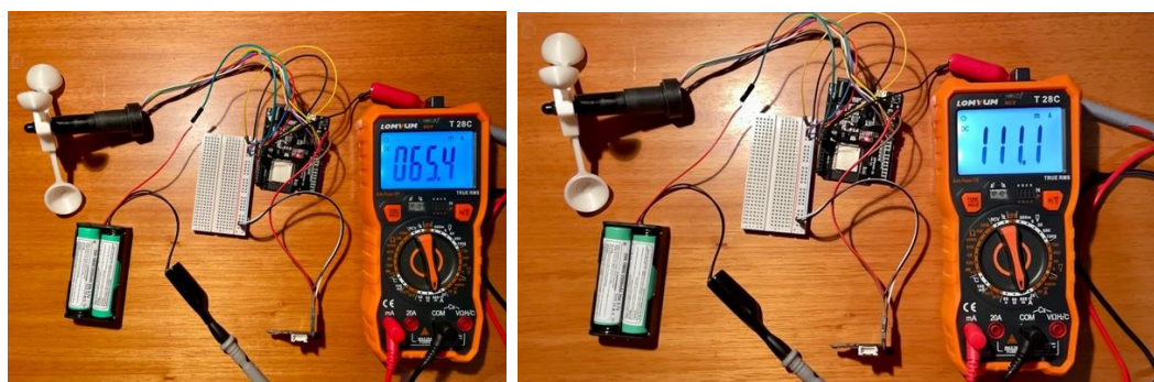
Ilustración 88. Medición del consumo de energía de la estación meteorológica. (izq.) Transmisión de datos desactivada; (der.) Transmisión de datos activada.
