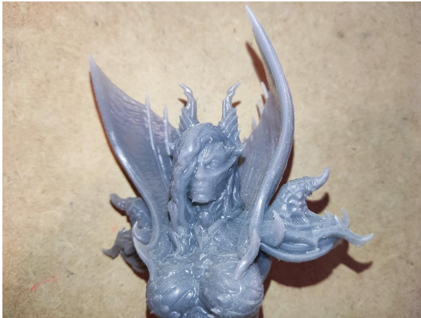
Ilustración 12 - Pieza con Lavado Incorrecto (Modelo 3D: ArchVillain Games)
