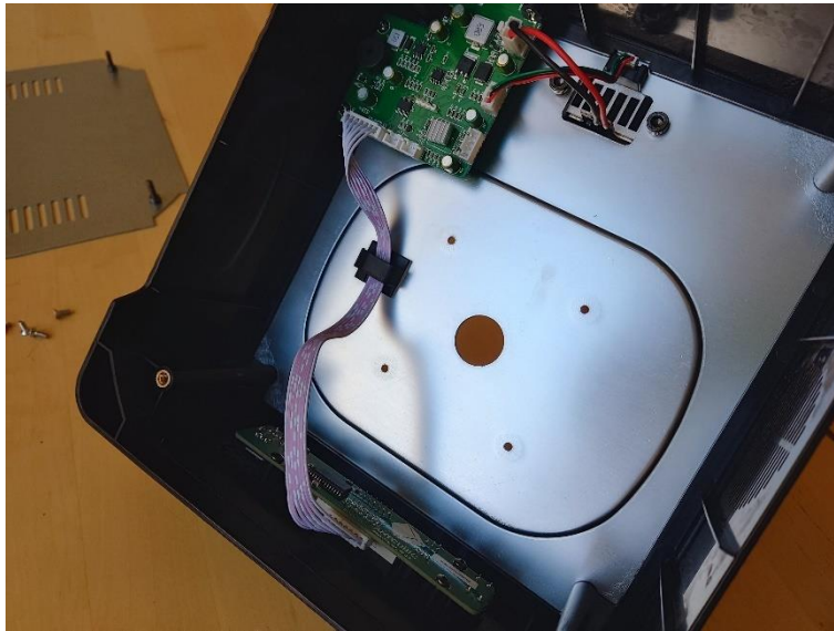
Ilustración 49 – Máquina W&C Anycubic; Cubierta Superior Base (Vista Inferior)
