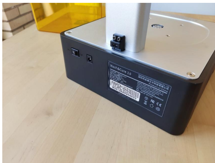
Ilustración 52 - Máquina W&C Anycubic; Envoltura Lateral Base (Orificios Alimentación)
