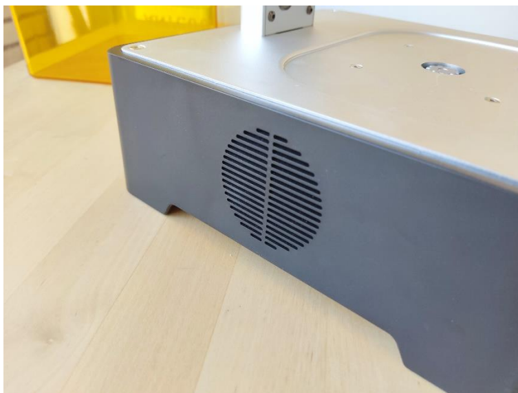
Ilustración 54 - Máquina W&C Anycubic; Envoltura Lateral Base (Rejilla de Ventilación)
