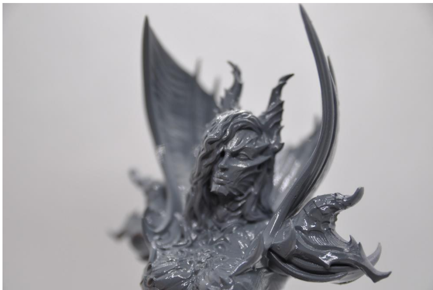
Ilustración 13 - Pieza con Lavado Correcto (Modelo 3D: ArchVillain Games)
