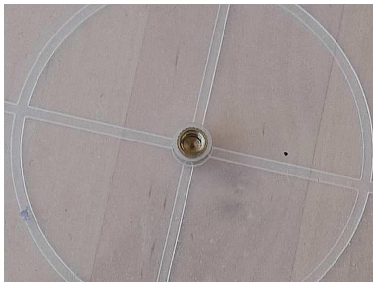
Ilustración 63 - Máquina W&C Anycubic; Cubeta de Lavado (Inserto Interno)
