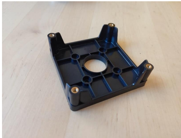
Ilustración 68 - Máquina W&C Anycubic; Soporte Motor Paso a Paso
