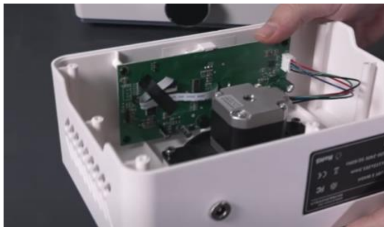
Ilustración 104 - Elegoo Mercury X Bundle; Placa Base Máquina Curado
