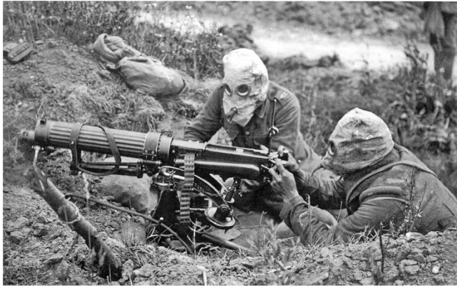
Figura 4: Ametralladora británica Vickers durante la batalla del Somme. Estas ametralladoras eran muy fiables, logrando 450 disparos/minuto sin descanso durante largas jornadas y parando únicamente para cambiar el agua que refrigeraba el cañón y para recargar. (Foto de: Wikipedia: https://upload.wikimedia.org/wikipedia/commons/7/7b/Vickers_machin
