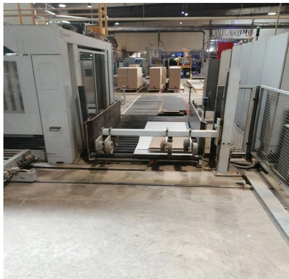
Ilustración 26: pórtico con ruedas prensoras que ayuda a evacuar la tabla.
