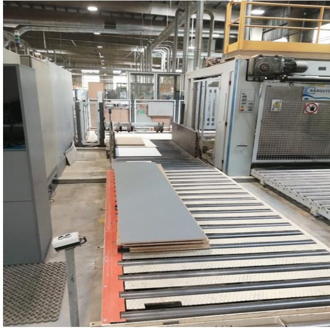
Ilustración 25: resultado tras la instalación de los caminos de rodillos
