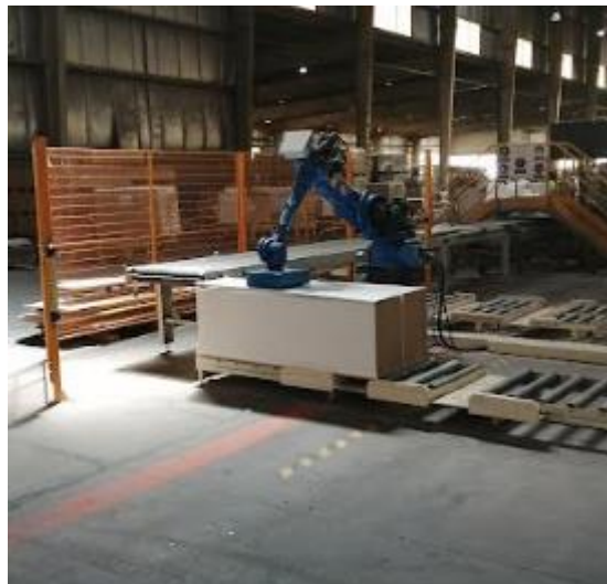
Ilustración 48: nuevo robot yaskawa cogiendo tablas.
