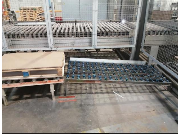
Ilustración 29: alimentación de pallet mediante rodillos locos.
