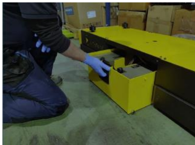
Ilustración 43: cambio manual de batería.
