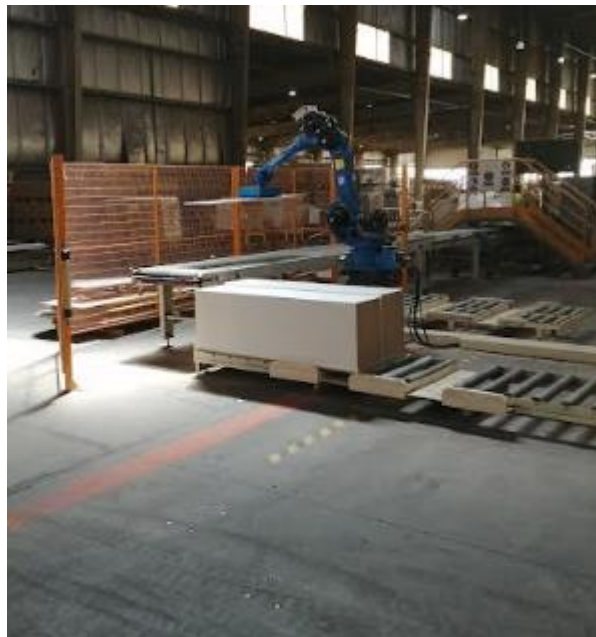
Ilustración 50: nuevo robot yaskawa depositando la tabla en la banda.
