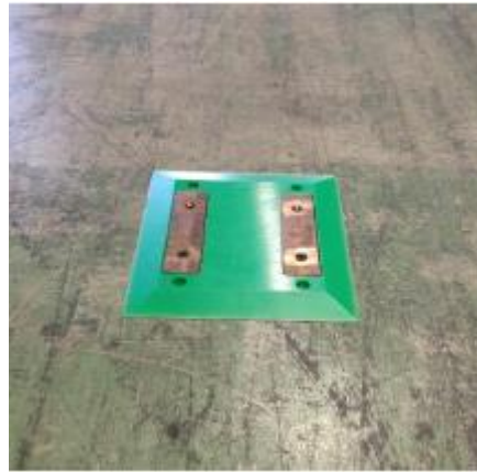
Ilustración 44: ejemplo carga batería por contacto en el suelo.
