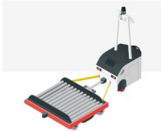
Ilustración 40: Ejemplo AGV tipo tractora.
