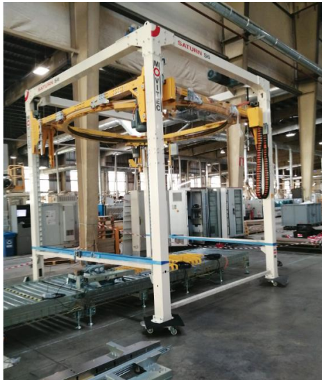
Ilustración 36: montaje anillo enfardadora Saturn S6.
