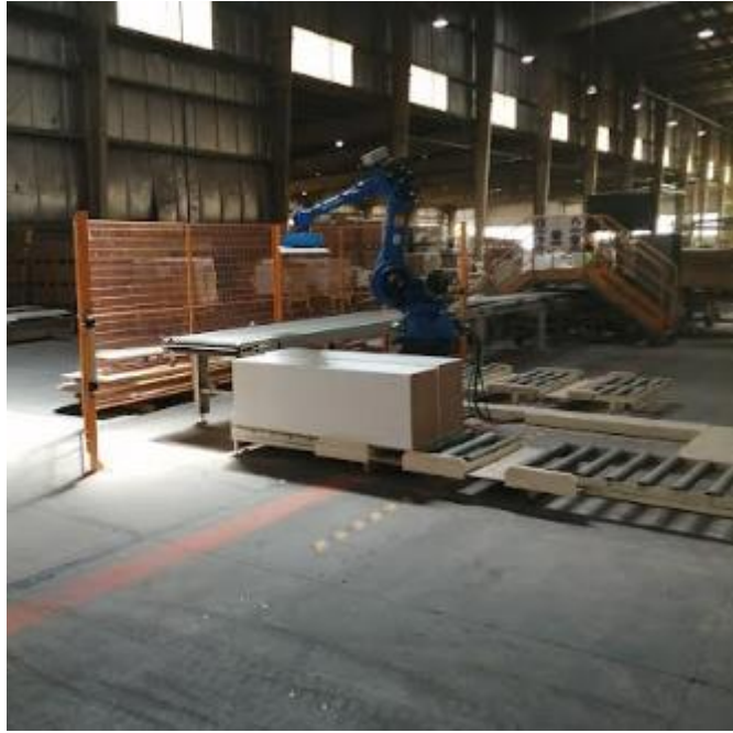
Ilustración 49: nuevo robot yaskawa desplazando la tabla.
