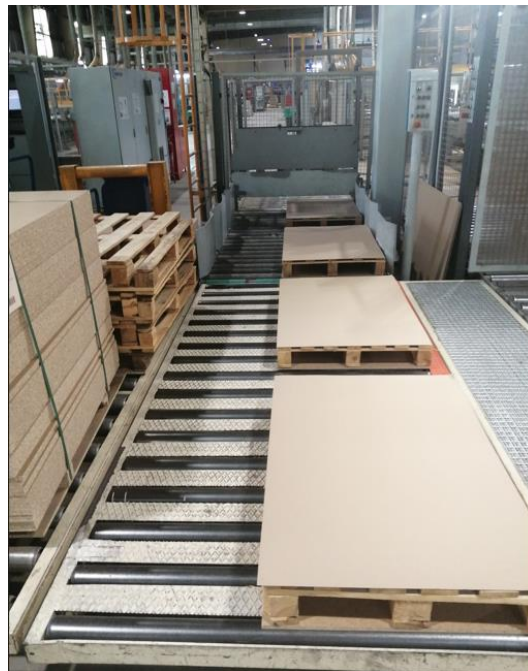
Ilustración 30: automatización entrada pallet línea.
