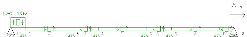
Figura 60: Esfuerzos Cortantes en el eje de entrada en 1º Marcha. Plano XY.
