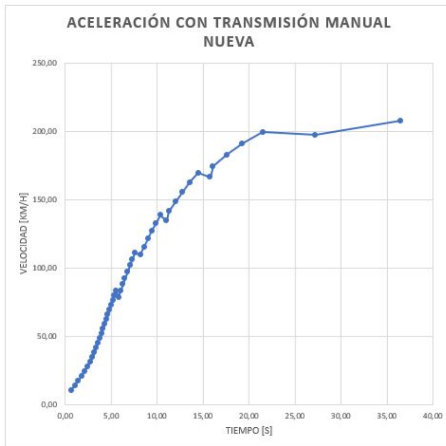
Figura 48: Aceleraciones 0 a 200 Km/h.
