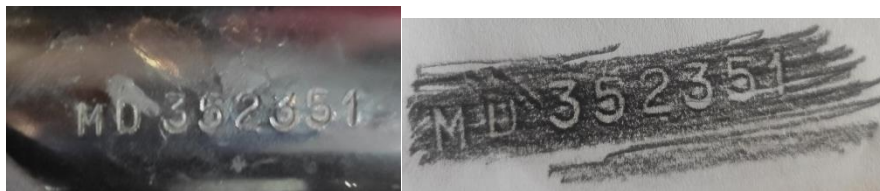
Ilustración 30. Troquelado número de bastidor en la columna de dirección (izquierda) y calcado (derecha)
