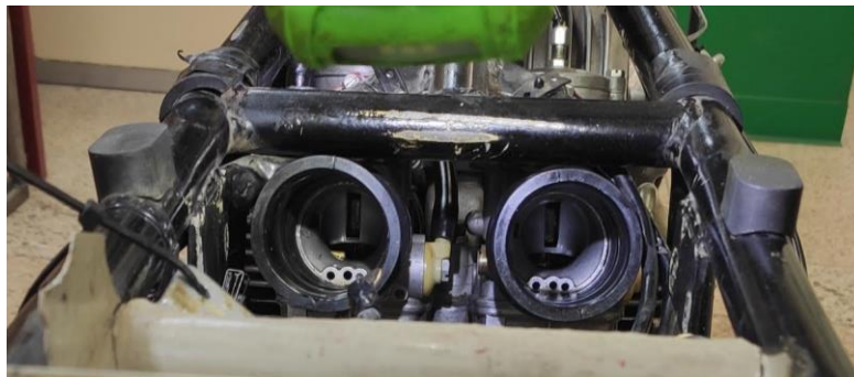
Ilustración 44. Los 2 carburadores una vez arregladas las 2 campanas
