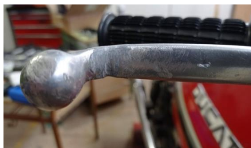
Ilustración 88. Maneta montada y lijada
