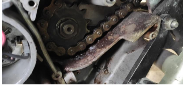
Ilustración 37. Piñón de la transmisión a la rueda
