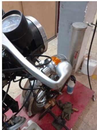
Ilustración 77. Maneta de freno doblada
