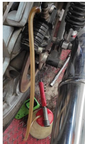
Ilustración 63. Proceso de sangrado de pinza de freno trasera
