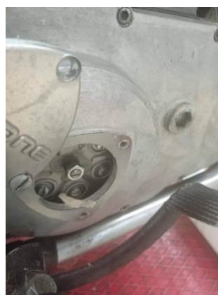
Ilustración 67. Tapa de llenado del cárter abierta
