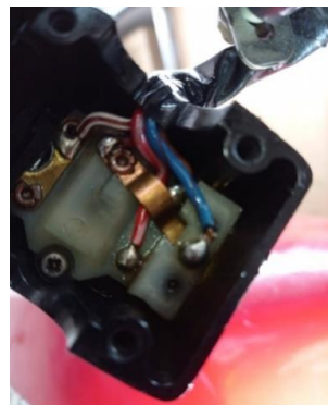
Ilustración 90. Contactos del botón de arranque tras su limpieza
