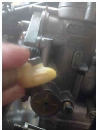
Ilustración 73. Filtro de gasolina desmontado
