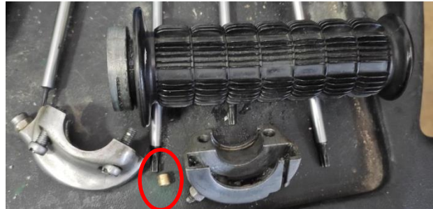
Ilustración 7. Empuñadura de la moto desmontada y el prisionero marcado con un círculo
