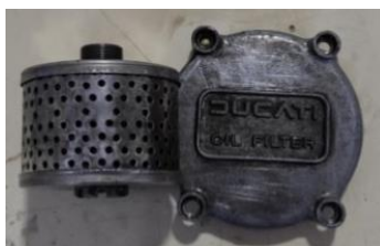
Ilustración 11. Filtro del aceite y tapa desmontados
