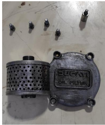
Ilustración 68. Filtro del aceite y tapa desmontados
