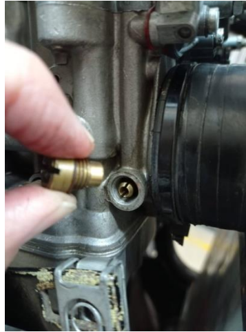
Ilustración 74. Paso calibrado con su alojamiento
