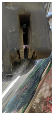
Ilustración 57. Pinza de freno
