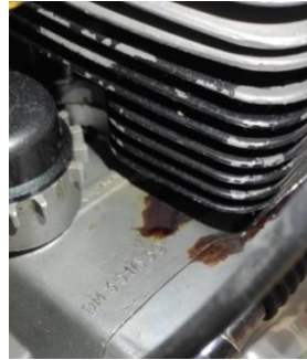
Ilustración 86. Aletas del motor para refrigeración por aire
