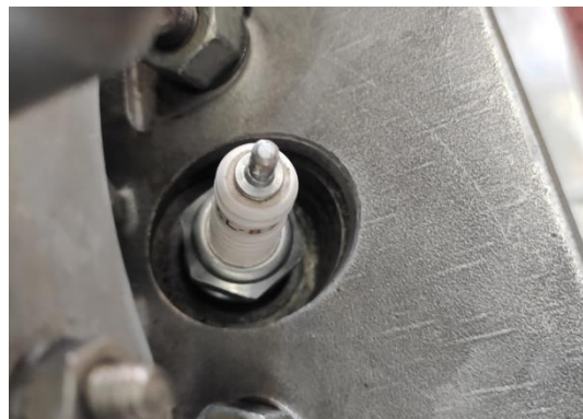
Ilustración 54. Bujía introducida en su posición
