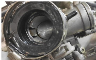
Ilustración 5. Campana del carburador atascada
