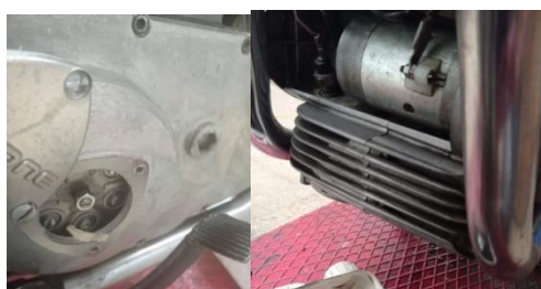
Ilustración 10. Tapa de llenado del cárter abierta (izquierda) y Cárter de aceite (derecha)
