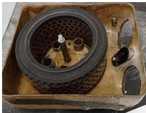
Ilustración 41. Filtro del aire desmontado
