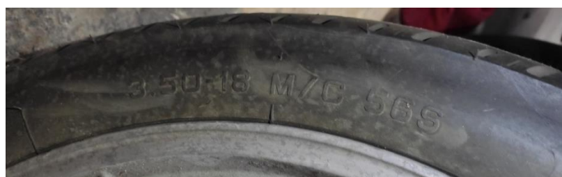
Ilustración 34. Nomenclatura neumático trasero
