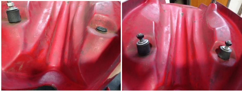
Ilustración 76. El antes (izquierda) y el después (derecha) del depósito tras pegar el taco de goma
