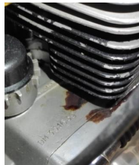
Ilustración 16. Aletas del motor para refrigeración por aire
