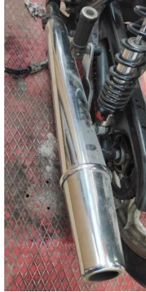
Ilustración 92. Tubo de escape con silenciador incorporado
