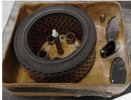
Ilustración 4. Filtro del aire desmontado
