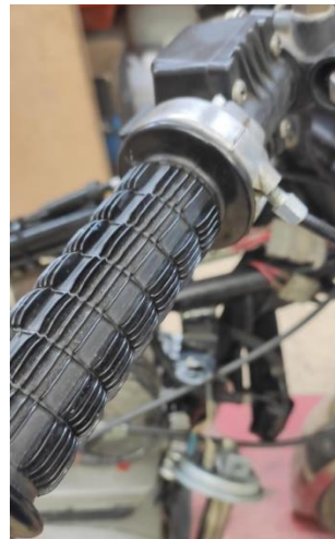
Ilustración 46. Puño del acelerador una vez arreglado y montado
