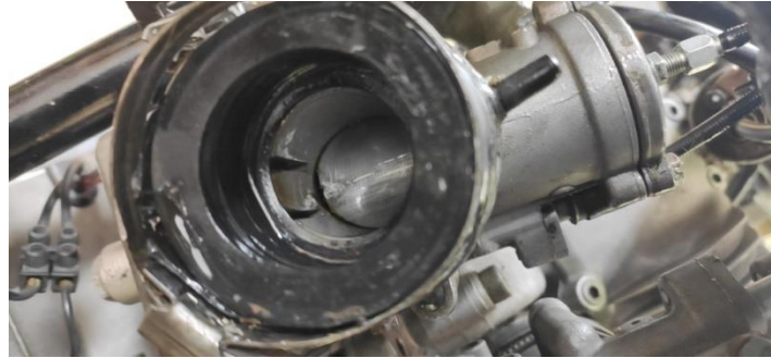
Ilustración 42. Campana del carburador atascada
