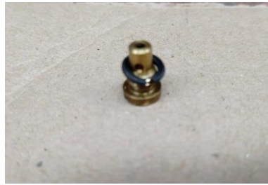
Ilustración 71. Paso calibrado del carburador con junta tórica estropeada
