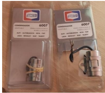
Ilustración 17. Condensador viejo (izquierda) y los nuevos condensadores (derecha)
