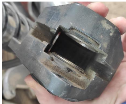
Ilustración 60. Pistones pinza de freno
