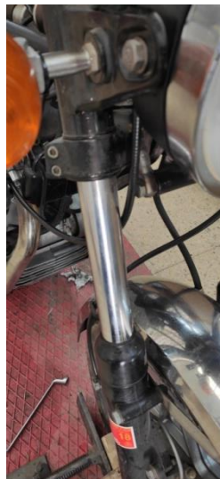
Ilustración 65. Horquilla telehidráulica de doble efecto
