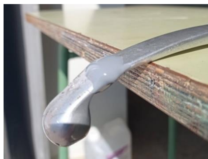
Ilustración 78. Maneta de freno enderezada y con la soldadura fría
