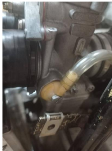
Ilustración 72. Filtro de gasolina montado
