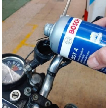
Ilustración 64. Rellenado depósito de líquido de frenos delanteros
