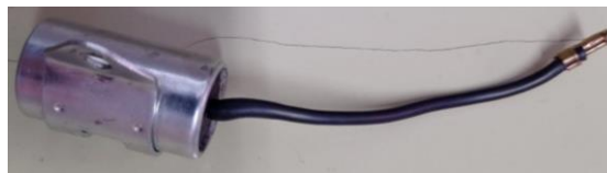
Ilustración 87. Condensador estropeado desmontado
