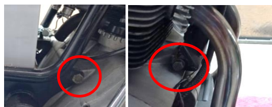
Ilustración 21. Anclajes del motor al bastidor
