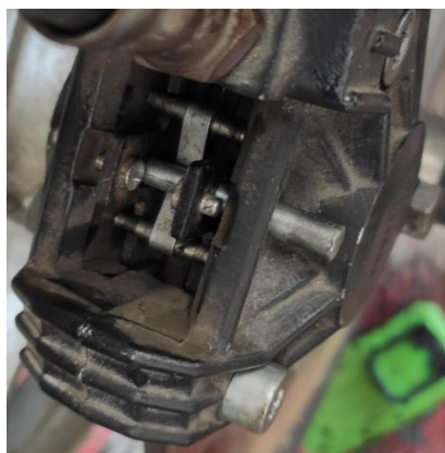
Ilustración 61. Pastillas colocadas en su posición con la pinza montada
