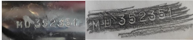
Ilustración 2. Troquelado número de bastidor en la columna de dirección (izquierda) y calcado (derecha)
