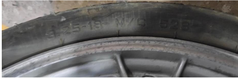
Ilustración 31. Nomenclatura neumático delantero
