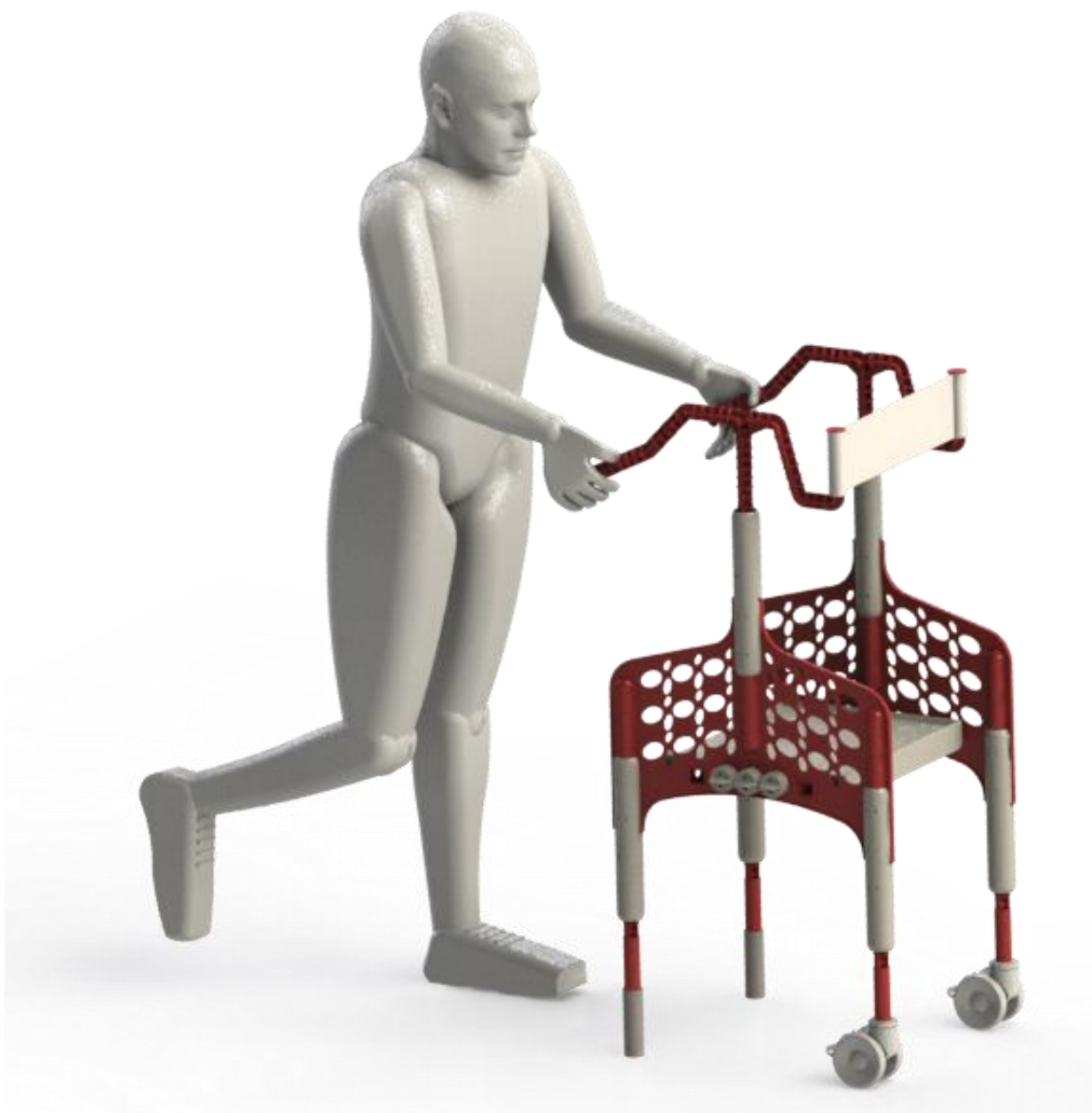
Figura 11.1.3 | Andador en uso de andar con las extensiones de pata y empuñadura máximas. Altura del modelo: 181 mm.
