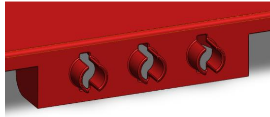
Figura 6.1.6 | Vista detalle tetones de fijación
