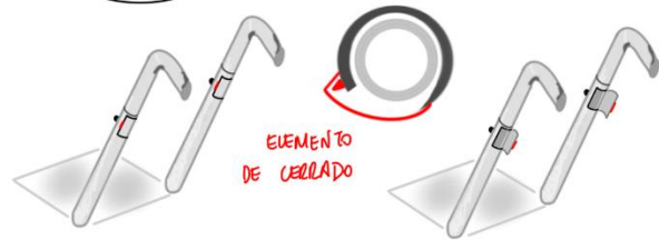
Figura 4.4.0 | Sistema de bisagra de regulación de altura
