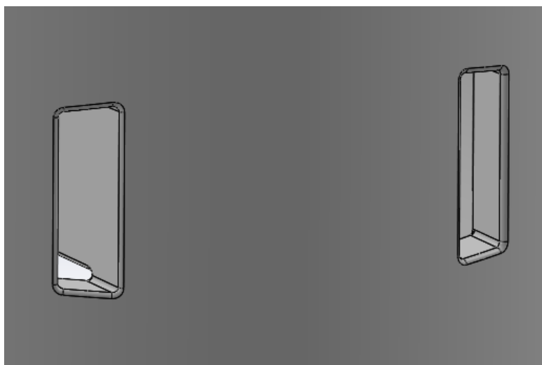
Figura 5.4.4 | Vaciados para el desmoldeo de la cabeza del clip
