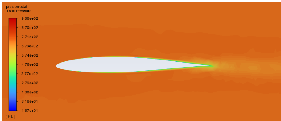
Figura 92. Vista local de la presión total del perfil NACA 63-210.
