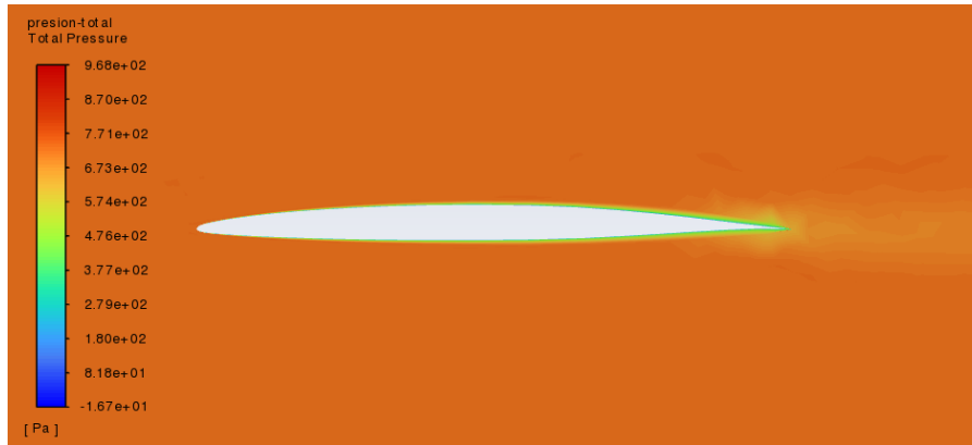
Figura 94. Vista local de la presión total del perfil NACA 66-206.
