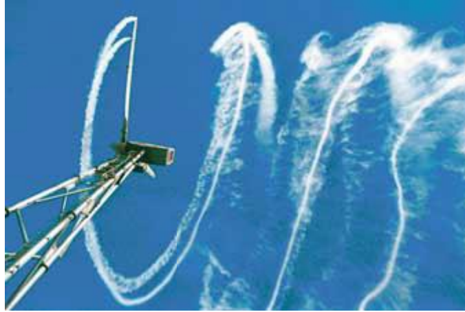
Figura 11. Estela de un aerogenerador [21].
