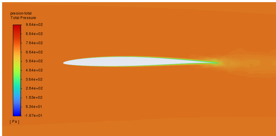
Figura 90. Vista local de la presión total del perfil NACA 63-206.
