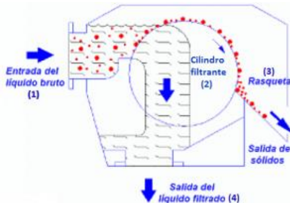
Figura 7. Funcionamiento del tamiz rotativo. (Gedar)
