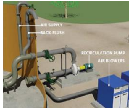
Figura 19. Sistema de inyección de aire mediante toberas. (Fuente: AEMA)
