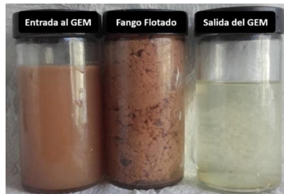
Figura 11. Muestra de fango espesado a la salida del sistema GEM. (Fuente: Clean Water Technology)
