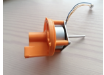
Fig.16: Motor en el bastidor.
