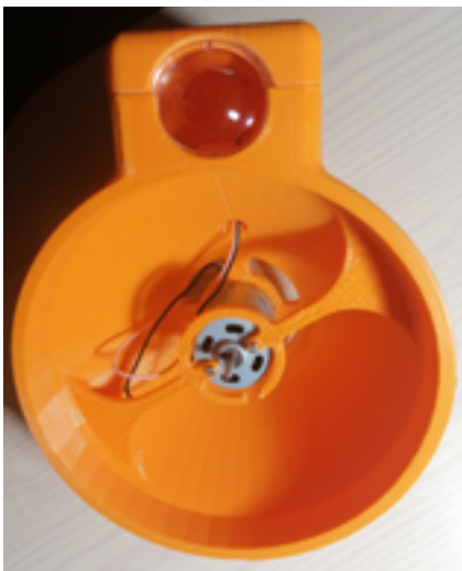
Fig.44: Prototipo con el motor colocado.
