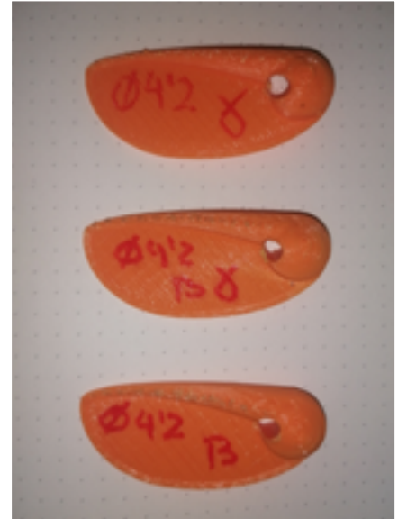
Fig.14: Los tres modelos de aspas impresas en 3D
