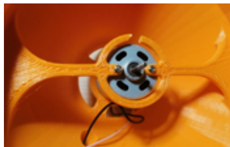
Fig.47 Motor sujetado por las fijaciones.
