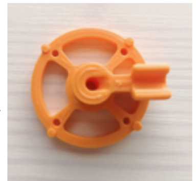
Fig.20: Nuevo bastidor con huecos.
