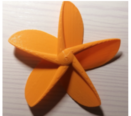
Fig.27: Hélice impresa en 3D
