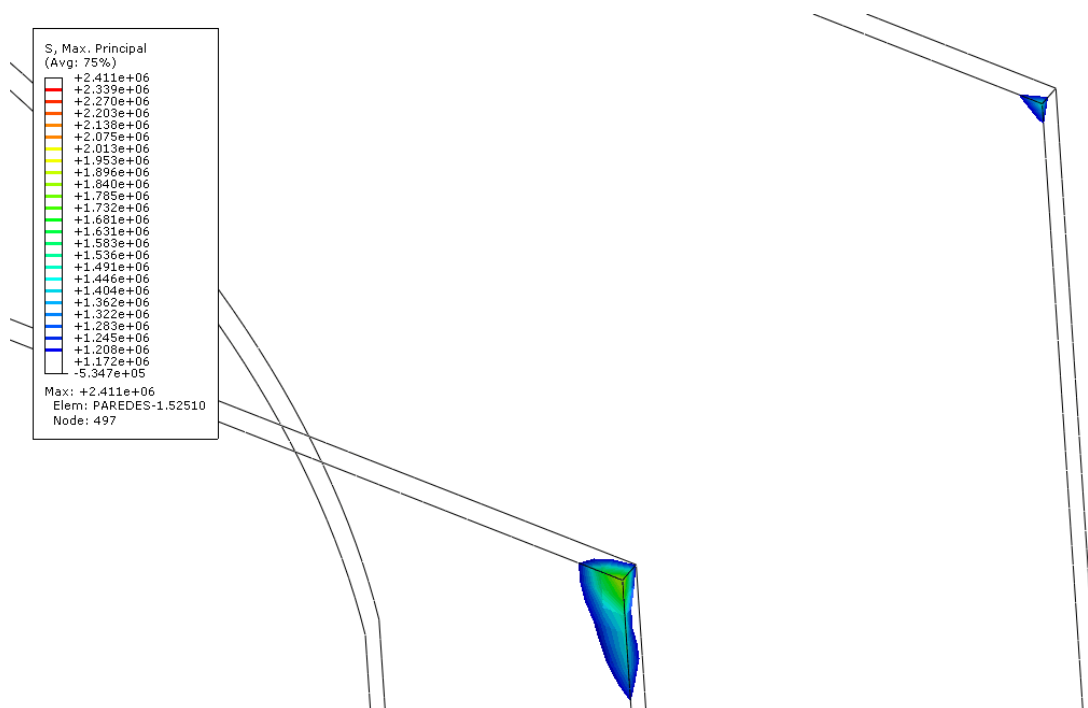
Figura 51. Distribución de tensiones máximas principales positivas en empotramiento sur para la H22 (Paredes de Piedra)
