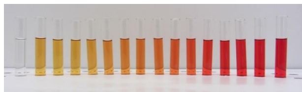
111 Figura 1. Imagen del experimento. 112 Ca(II) rango 0-16 mg/lit, GBHA 0.06% m/v, en metanol.
