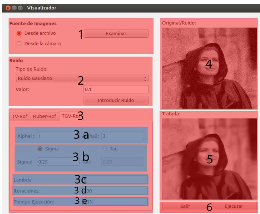
Figura D.6: Esquema de las distintas zonas de la interfaz de visualización.
