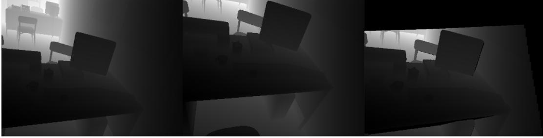
Figura 3.2: Prueba del correcto funcionamiento de la virtualización de mapas de profundidad. Mapa original capturado en la referencia centrada  $r$  (Izquierda). Mapa que se quiere trasladar a  $r$  (Centro). Mapa resultante, ya en  $r$  (Derecha)
