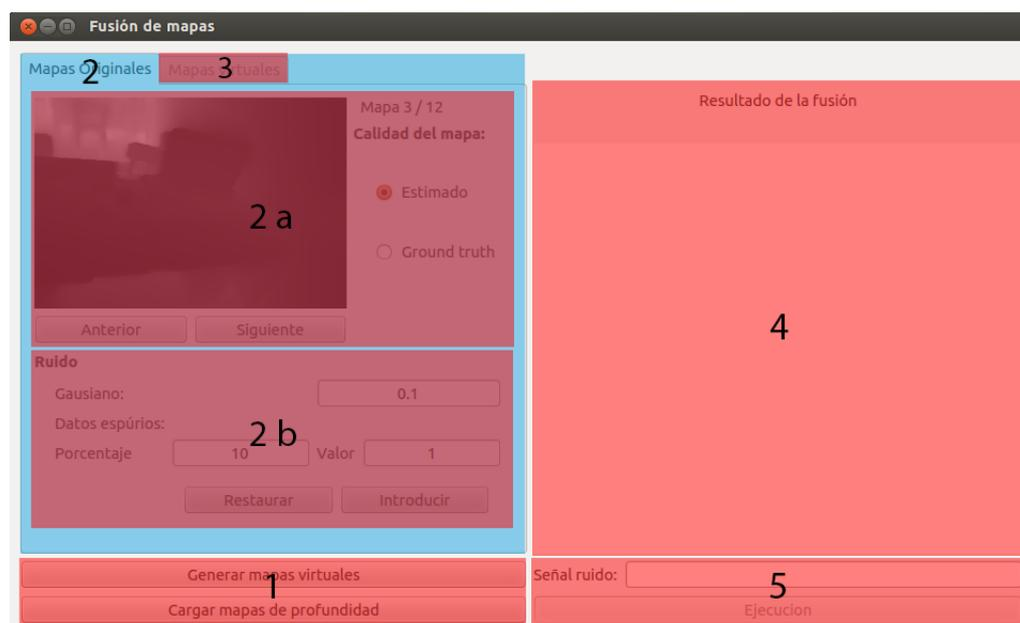
Figura D.10: Esquema de las distintas partes que conforman la interfaz de la fusión de mapas.
