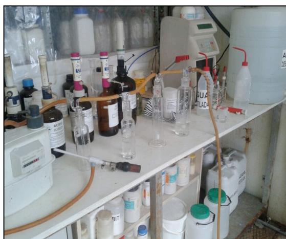
Fig. 6 y 7. Distribución de borboteadores para el análisis de gases en la torre de seguridad.
