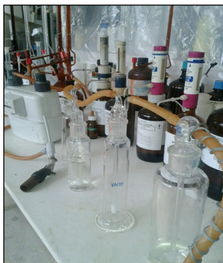
Fig. 6 y 7. Distribución de borboteadores para el análisis de gases en la torre de seguridad.
