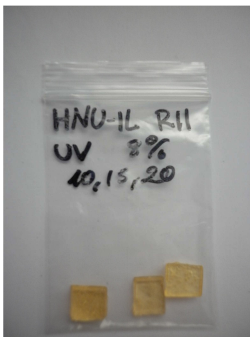
Figura I.21.- Muestra HNU470 IL RII 8% curada con UV.
