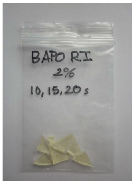
Figura H.1.- Muestra BAPO RI 2%, curado con luz visible.
