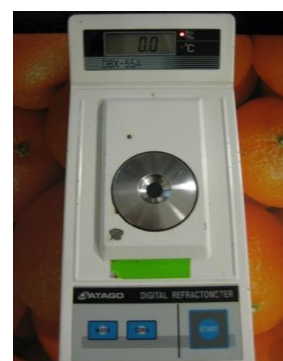
Fotografía 5: Refractómetro ATAGO DBX 55 a
