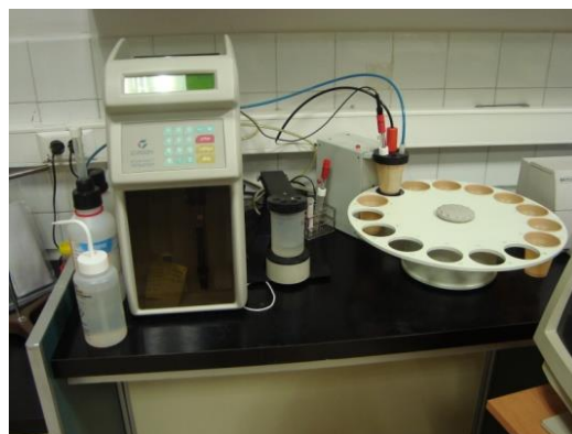
Fotografía 6: Titulador automático Crison Compact Titrator para la determinación de la acidez.
