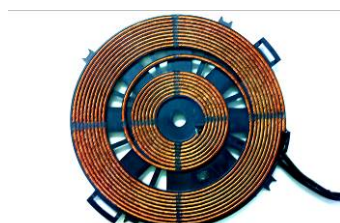
fig . 4.4 Inductor de 180 mm de 18 espiras ambivalente en IH6 y Multiplex
