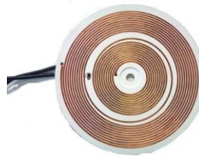
fig. 5.4. Prototipo en silicato de calcio del inductor de 21 cm y 21 espiras, ajustado a booster a 20 kHz con recipiente Zenith .
