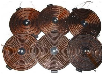
fig. 5.3. Conjunto de inductores "flexibles" para encontrar puntos de operación concretos.
