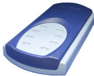
Fig. A7-1 PICO data logger empleado para el registro de temperaturas en los IGBT y puente de diodos
