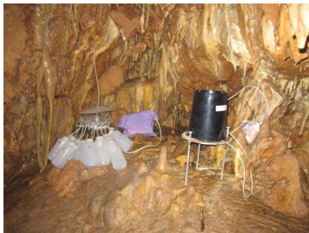
Fig 3.1. Tomamuestras automatizado y pluviómetro instalados en la cueva
