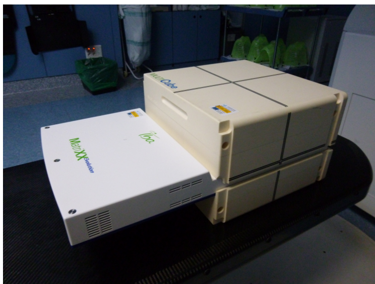
Figura 5.4: Dispositivo MatriXX introducido dentro del cuerpo de un maniquí de agua sólida.
