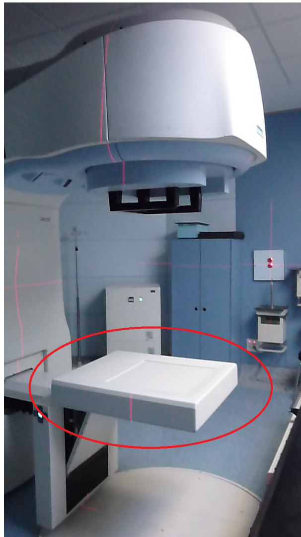
Figura 5.2: Acelerador lineal Oncor 6MW del Hospital Clínico Lozano Blesa. Dispositivo EPID resaltado en rojo.
