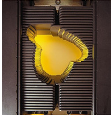
Figura 1.5: Sistema colimador multiláminas.
