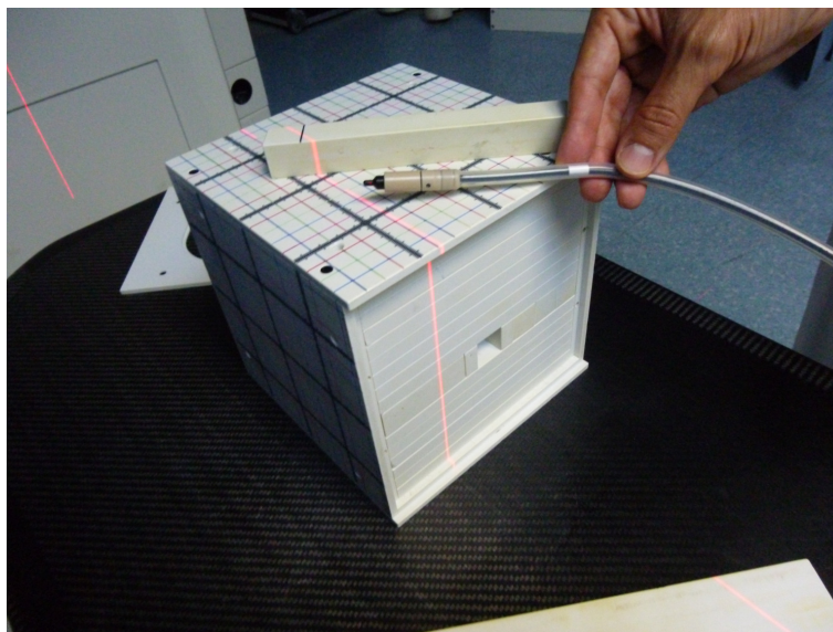
Figura 5.1: Maniquí relleno de bloques de agua sólida que permiten dejar un hueco en aquél punto en el que se quiere añadir una sonda de medición.
