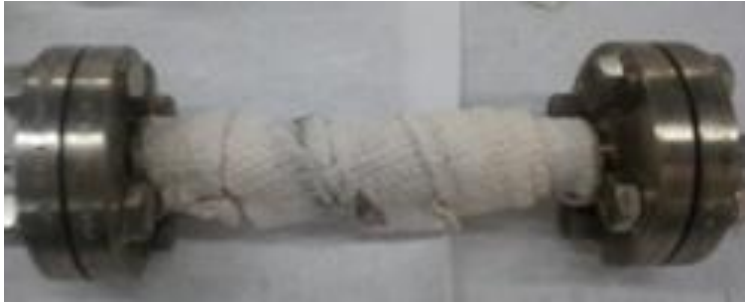
Figura A1.17: Manta de fibra cerámica en el reactor secundario.
