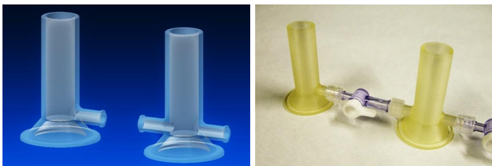
Figura E.1: Diseño tridimensional de los componentes del gradient maker (izquierda), y piezas fabricadas por prototipado rápido, ensambladas (derecha).
