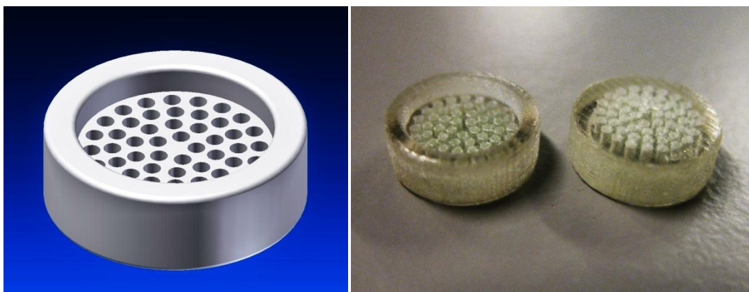
Figura B.1: Representación tridimensional de un disco poroso (izquierda) y discos porosos fabricados por prototipado rápido (derecha).
