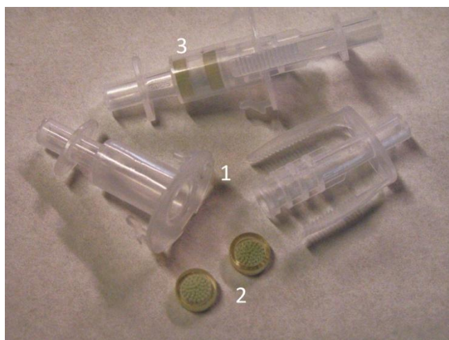
Figura 2.1: (1) Cámara EBERS® P3D-6, (2) discos porosos y (3) montaje con un andamio de PLLA.
