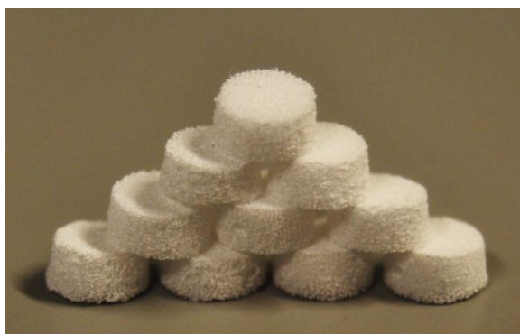
Figura 1.1: Andamios estructurales de ácido poli-L-láctico (PLLA).
