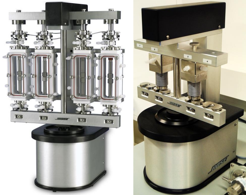
Figura C.1: Sistema Biodynamic 5210 multi-espécimen (izquierda), y sistema generador de pulso fluídico (derecha).
