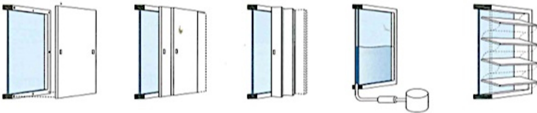
Figura 29. Tipos de protecciones solares internas
