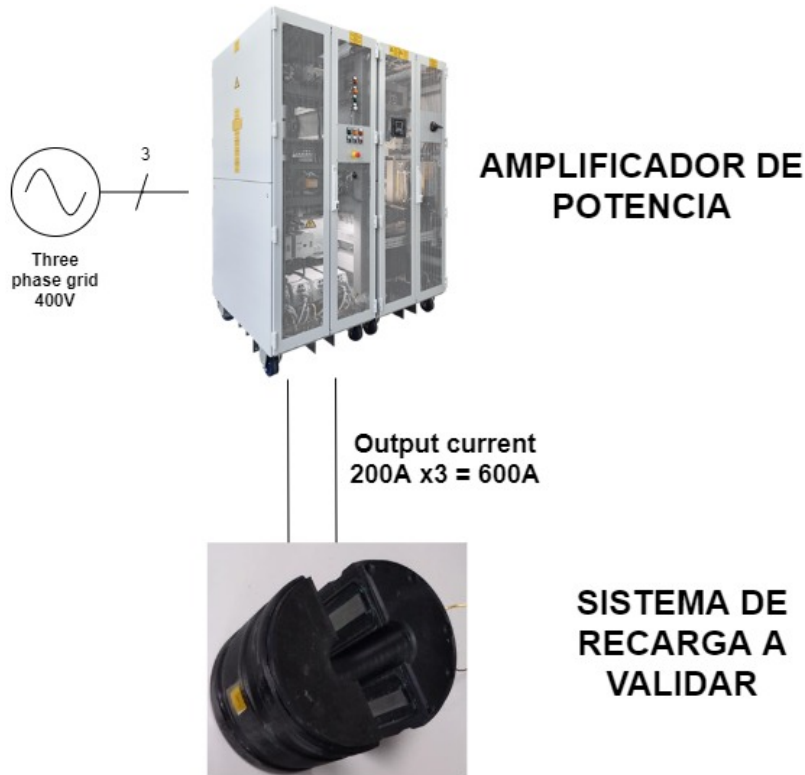
Figura B.2: Esquema conceptual de la prueba a realizar para la verificación del sistema de recarga por inducción de un sistema robótico cognitivo aéreo.
