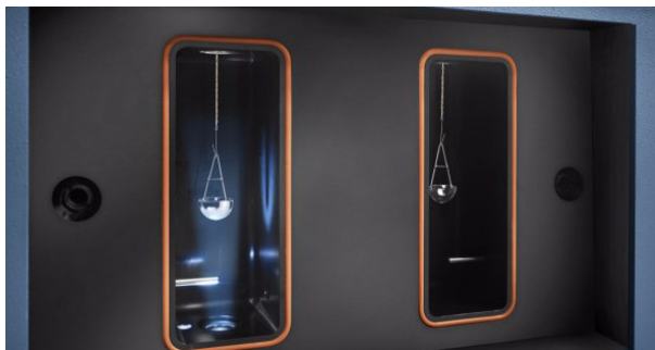
Figura 2.11. Detalle de la cámara de medida del equipo VTI-SA+ de la casa comercial TA Instruments, utilizado para la medida gravimétrica de la adsorción de vapor de agua.
