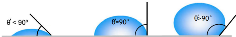
Figura 2.25. Definición geométrica del ángulo de contacto de una gota de agua sobre una superficie. (a) Superficie hidrófila, (b) Régimen de transición, (c) Superficie hidrófoba.
