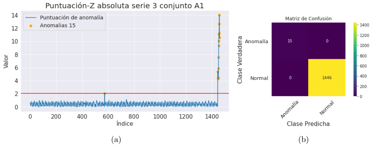
Figura 5.2: (a) Puntuación de anomalía obtenida por el método de las puntuaciones-Z absolutas, junto a las anomalías reales y el umbral ideal (rojo), aquel umbral que mejor métrica F1 obtenía. (b) Matriz de confusión obtenida usando como umbral \theta el umbral ideal.
