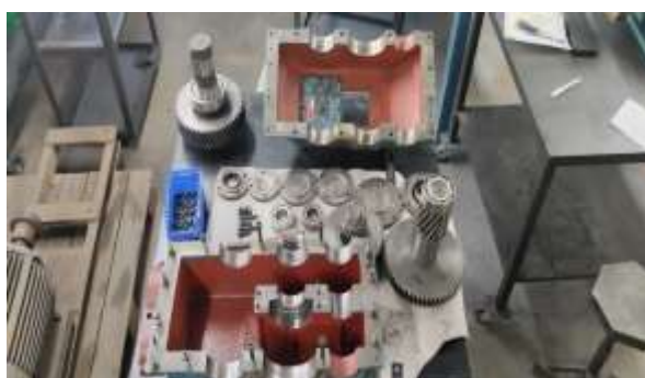
Ilustración 4. Despiece completo de la reductora
