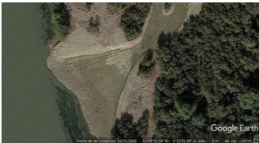
Figura 42. Labrado de sedimentos Curage en Alcalá de Ebro. Fuente: Google Earth
