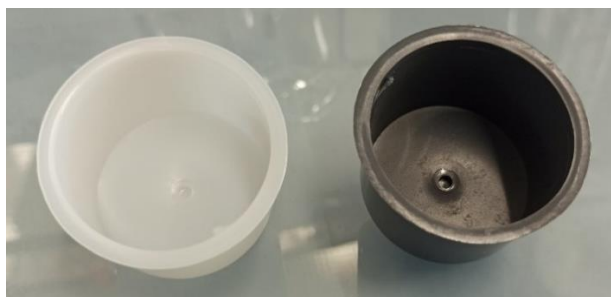
Figura 1. Muestras de plástico virgen (izquierda) y 25% reciclado (derecha)
