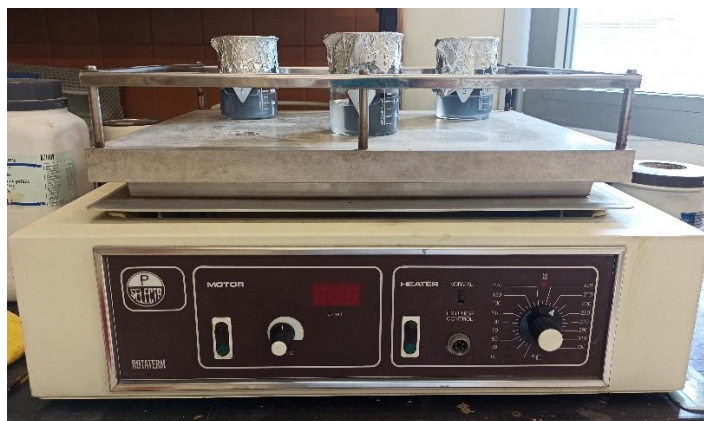
Figura 3. Agitador orbital y de vaivén Rotaterm JP SELECTA, con 3 réplicas del análisis
