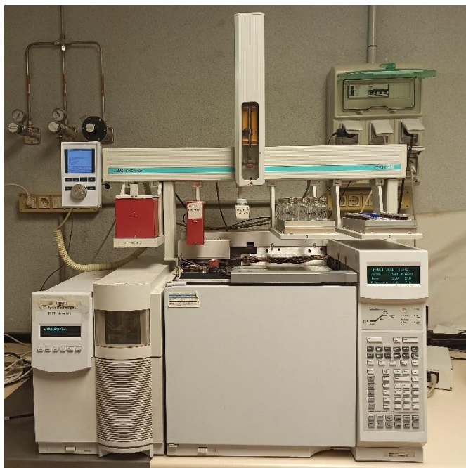
Figura 2. Cromatógrafo de gases acoplado a un detector de masas
