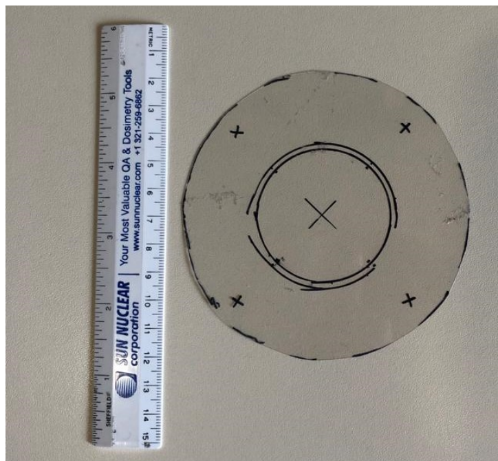
Figura 13: Plantilla dibujada sobre una lámina de plástico transparente. Recortada al diámetro total de la cámara pozo. Las cuatro cruces exteriores coinciden con los tornillos de la cámara para fijar la plantilla sobre ella. La circunferencia marca la posición del aplicador. La cruz interior indica el centro de la cavidad de la cámara.
