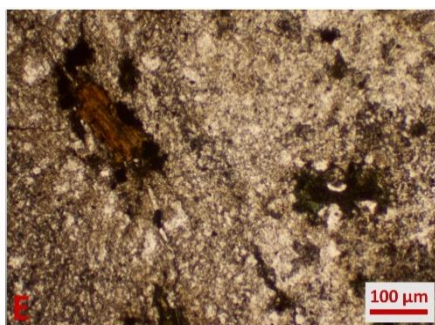
Figura 13. A) Muestra de visu RSM-9. B) Textura general de la roca. C) Plagioclasas con maclado lamelar. También se observa la matriz de cuarzo microcristalino. D) Cristal idiomorfo de feldespato alcalino con maclado de Carlsbad. E) Cristal de biotita a la izquierda, se observa su familia de planos de exfoliación perfecta. A su derecha se muestra un cristal de clorita.
