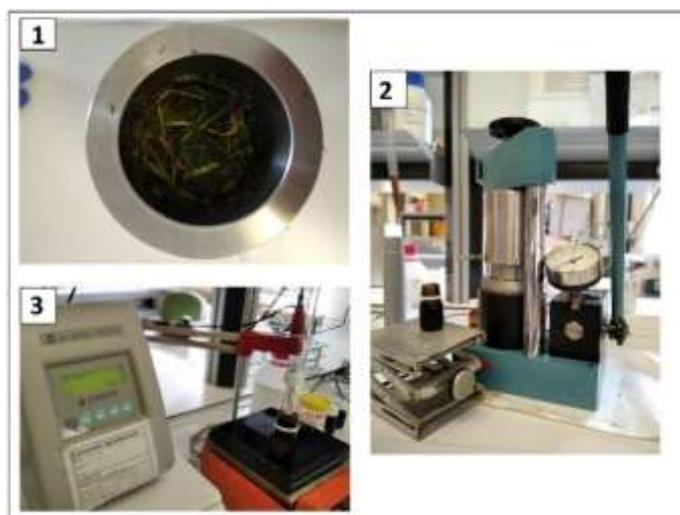
*Ilustración 13 - Muestra de ensilado en el cilindro de la prensa (1) - Prensa y obtención del extracto (2) - Medición del pH del extracto (3)*
