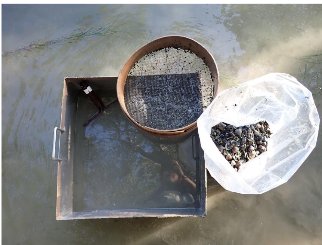
Figura 9. Cuadrado de 50x50 cm, pala, criba y bolsa con muestra de almeja asiática.
