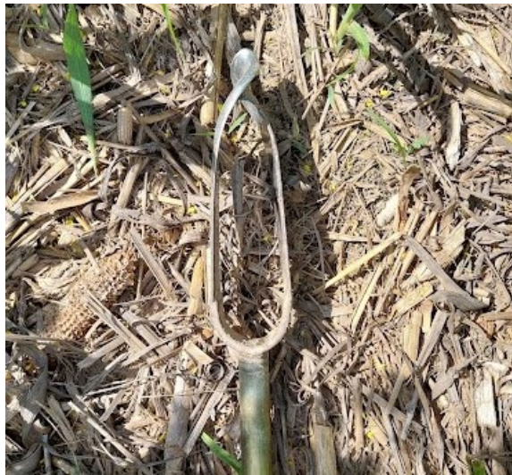
Figura 4. Imagen de barrena Edelman sobre la cobertura del suelo.
